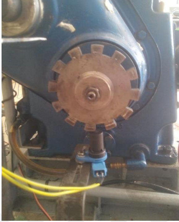
Şekil 3. 4 Krank sensörü ve 12 dişten oluşan şaft
