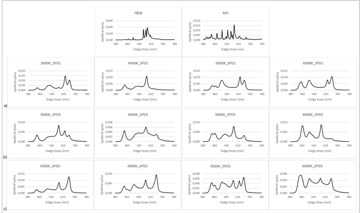
Şekil 3.1 YBSB, MH ve LED spektrumlar a)Ra: 55 b)Ra: 75 c)Ra: 95
