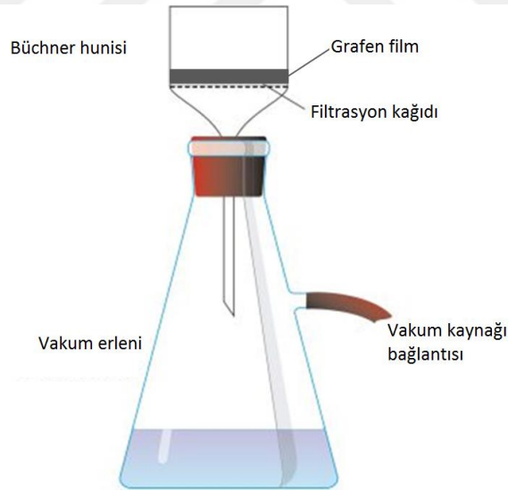
Şekil 5.1 Grafen oksitin vakum filtrasyon yöntemi ile eldesinin şematik gösterimi
