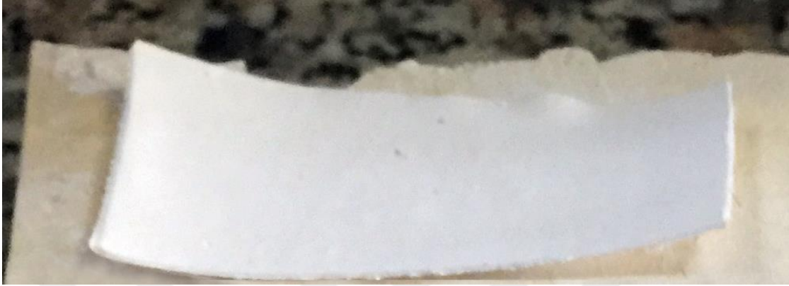
Şekil 7.4 İnce numunelerde sinterleme sonrası meydana gelen bükülme
