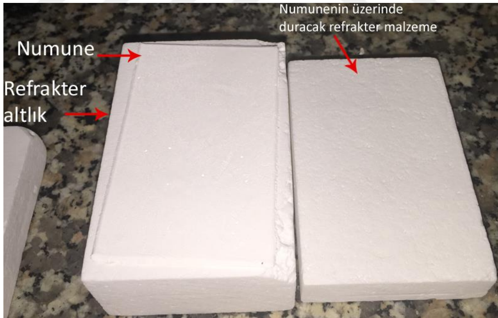
Şekil 7.5 İnce numunenin bükülmesini engellemek için kullanılan refrakter altlık ve kapak
