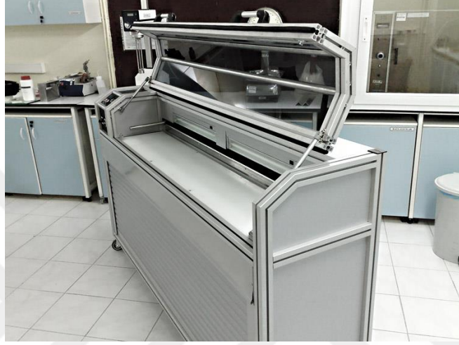
Şekil 4.1 YTÜ - Metalürji ve malzeme bölümü seramik laboratuvar şerit döküm cihazı
