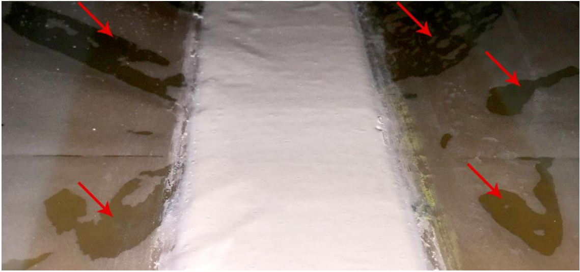
Şekil 7.3 Fazla vazelin kullanılması sonucu bir hafta sonra bile kurumamış olan numune örneği, ıslak alanlar işaretlenmiştir.
