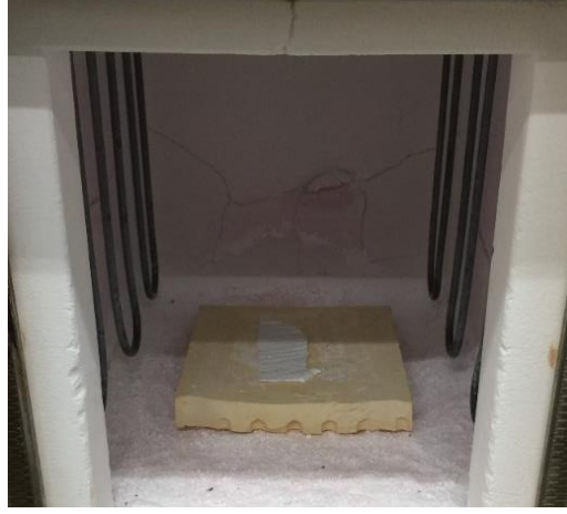
Şekil 4.3 YTÜ – Metalürji ve malzeme bölümü seramik Laboratuvar Sinterleme Fırını
