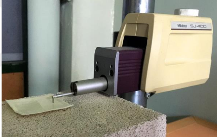
Şekil 4.4 YTÜ – Metalürji ve malzeme bölümü malzeme Laboratuvar Yüzey pürüzlülüğü ölçüm cihazı “Mitutoyo SJ400”
