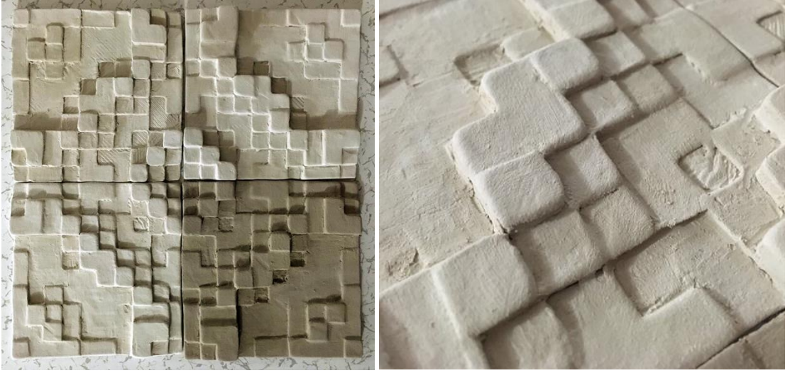
Şekil 6.23 - 3D seramik yazıcı ile üretilen reflectarray anten (koyu renkli parça henüz kurumamıştır)
