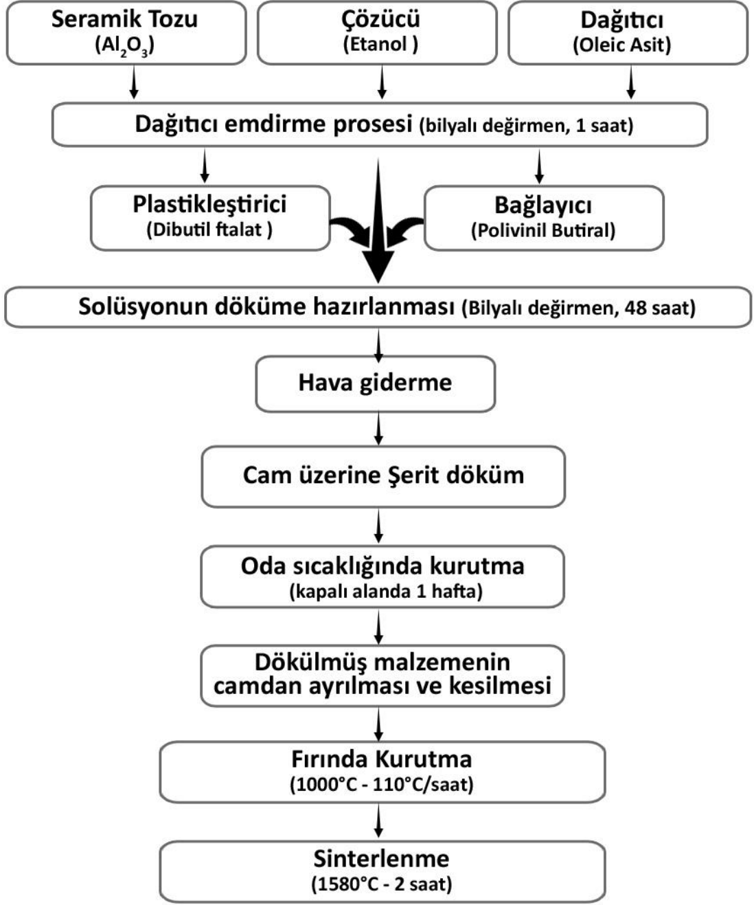
Şekil 5.6 Şerit döküm prosesi akım şeması
