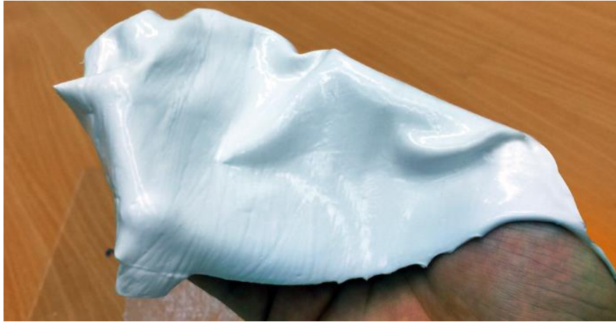
Şekil 5.3 Sinterleme öncesi malzemenin esneklik durumu
