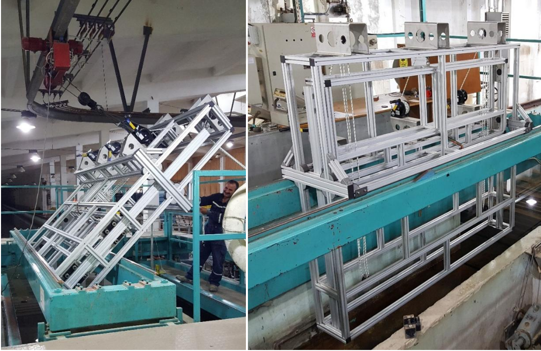
Şekil 7. 18 Asansör sisteminin deney arabasına yerleştirilmesi
