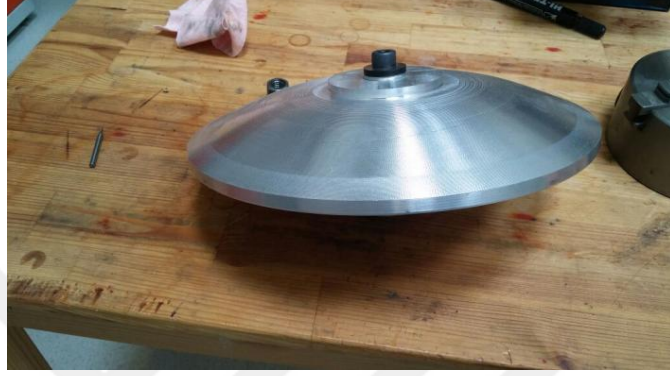
řekil 7. 5 Pervanenin iřleneceėi alüminyum blok
