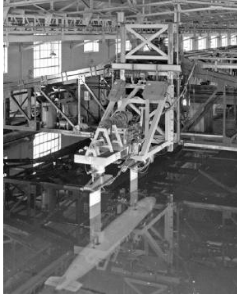
Şekil 3. 6 Qinetiq İngiltere’de düşey düzlemsel hareket mekanizması ile denizaltı deneyleri [4]
