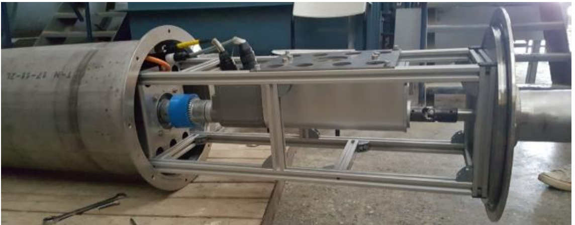
Şekil 7. 8 Basınçlı kap içinde dinamometre yerleşimi
