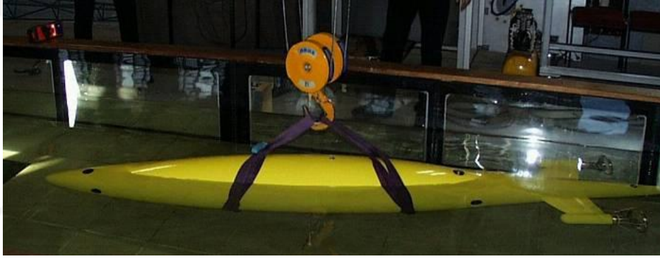
Şekil 3. 10 SVA Potsdam'da hazırlanan bir denizaltı kendinden hareketli modeli [50]
