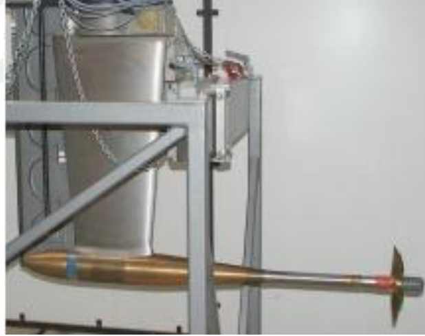
Şekil 4. 2 Pervane açık su deney düzeneği [57]
