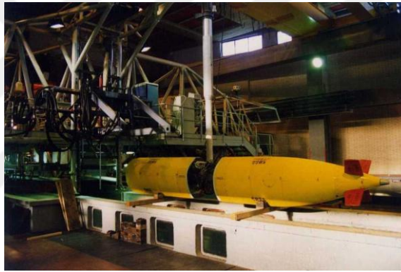
Şekil 3. 7 INSEAN’da yapılan deneylerden denizaltı modeli görüntüsü [48]
