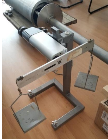
Şekil 7. 21 Sevk dinamometresinin kalibrasyonu yapılırken
