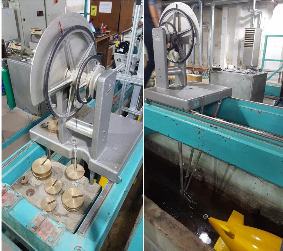
Şekil 7. 22 Atwood cihazı ve yük hücresinin sistem üzerinde kalibrasyonu
