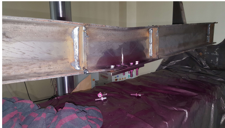
Şekil 4.12 15 cm Çelik Plaka İle Güçlendirilmiş Kirişin Göçmesi
