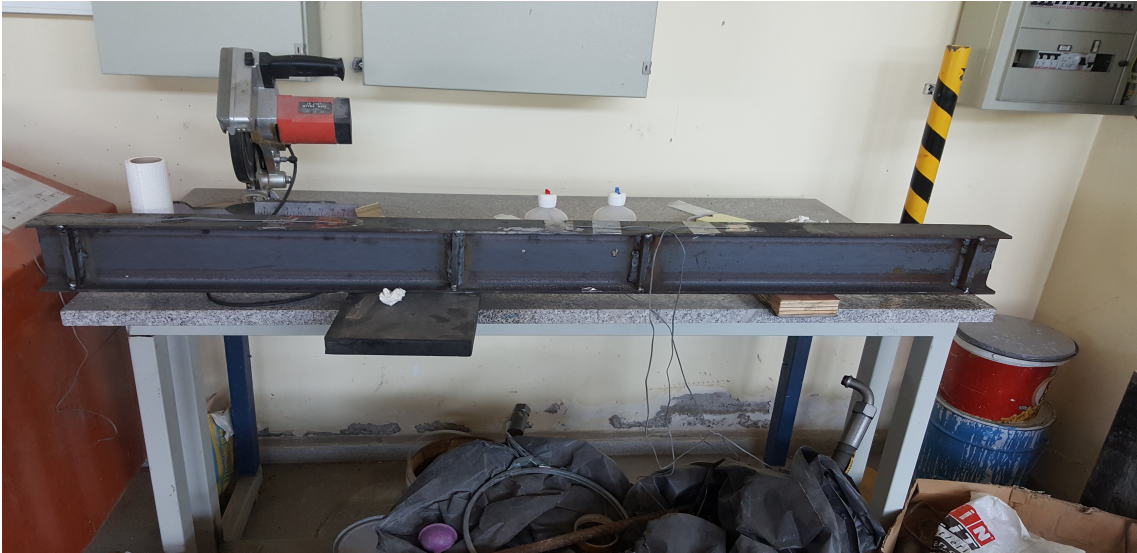
Şekil 3.23 Tüm Strain Gauge'nin Yapıştırılması
