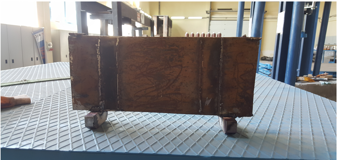
Şekil 4.5 Dört Noktalı Eğilme Deneyi İçin Yükleme Aparatı
