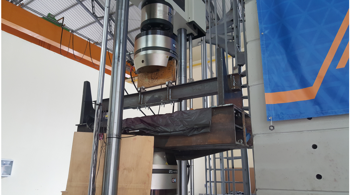
Şekil 4.14 51 cm Çelik Plaka İle Güçlendirilmiş Kirişin Deneyi
