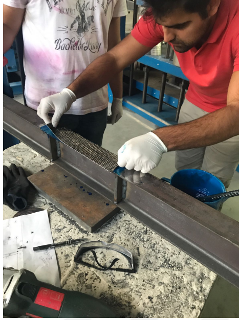
Şekil 4.20 CFRP şeridinin ilk katının yapıştırılması
