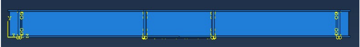
Şekil 3.19 CFRP malzemesiyle Güçlendirilmiş Çelik Kiriş
