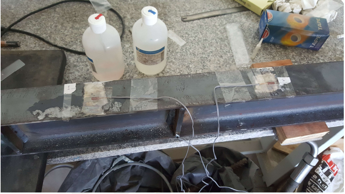
Şekil 3.22 Strain Gauge'nin Yapıştırılması
