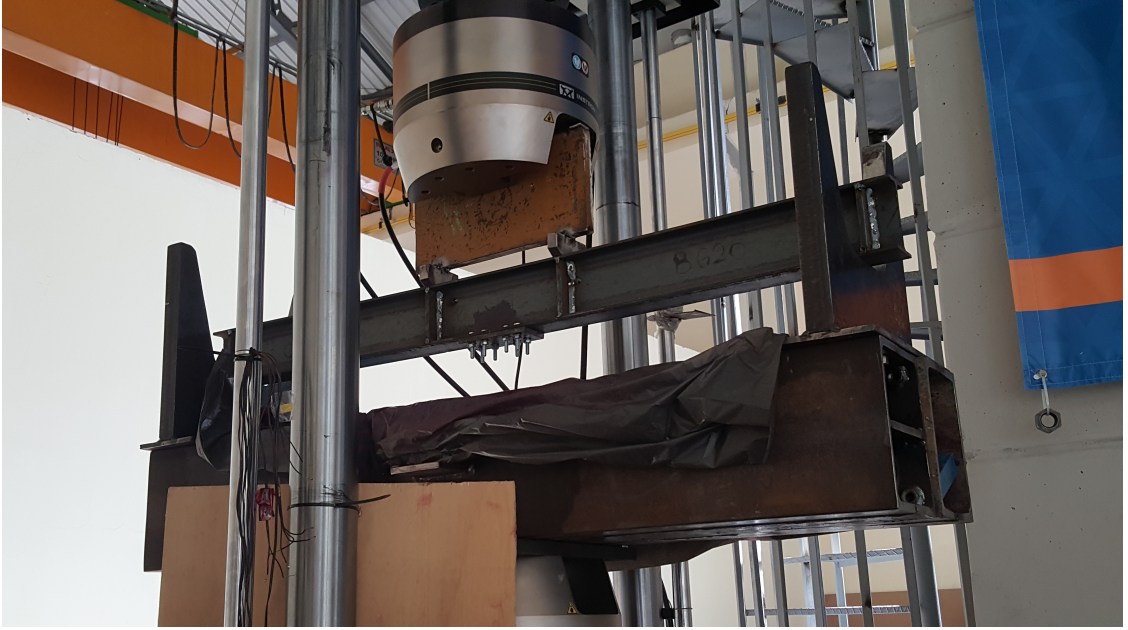
Şekil 4.11 15 cm Çelik Plaka İle Güçlendirilmiş Kirişin Deneyi
