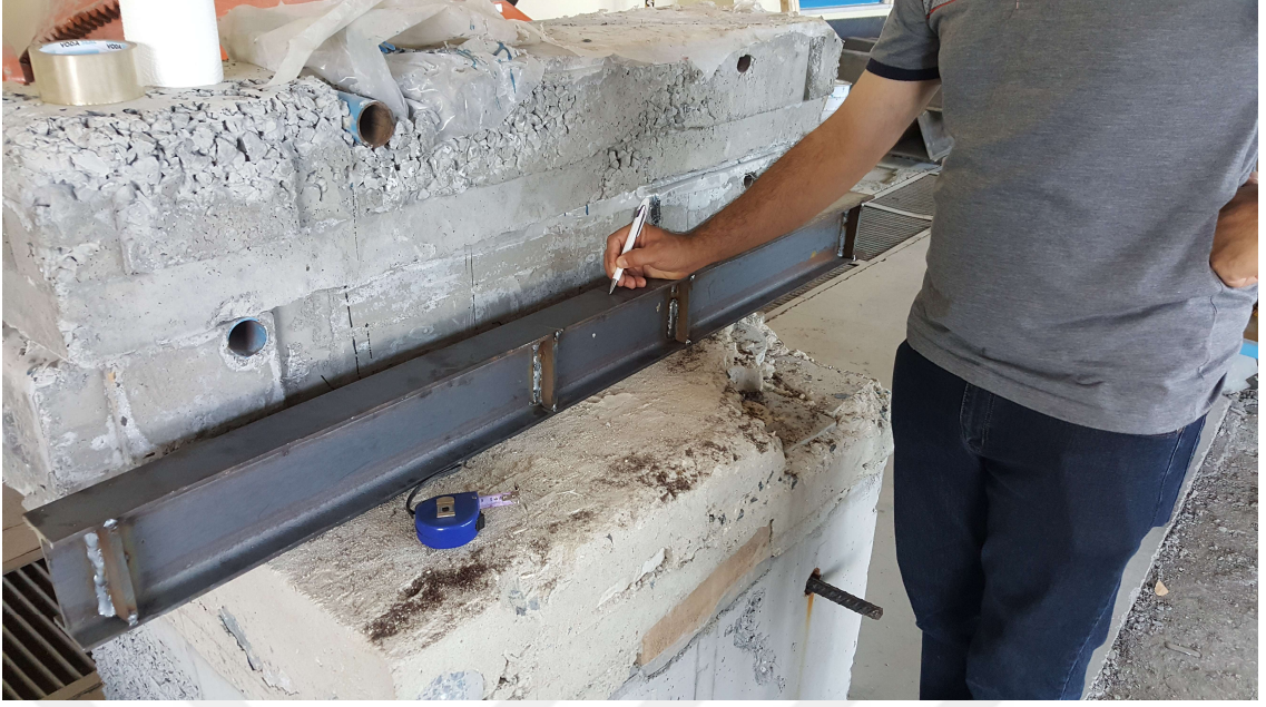
Şekil 3.20 Yapıştırılacak Strain Gauge'nin Yerlerinin İşaretlenmesi
