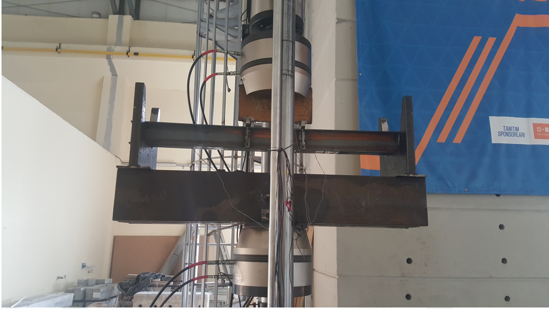
Şekil 3.26 Statik Olarak Dört Noktalı Eğilme Deneyi
