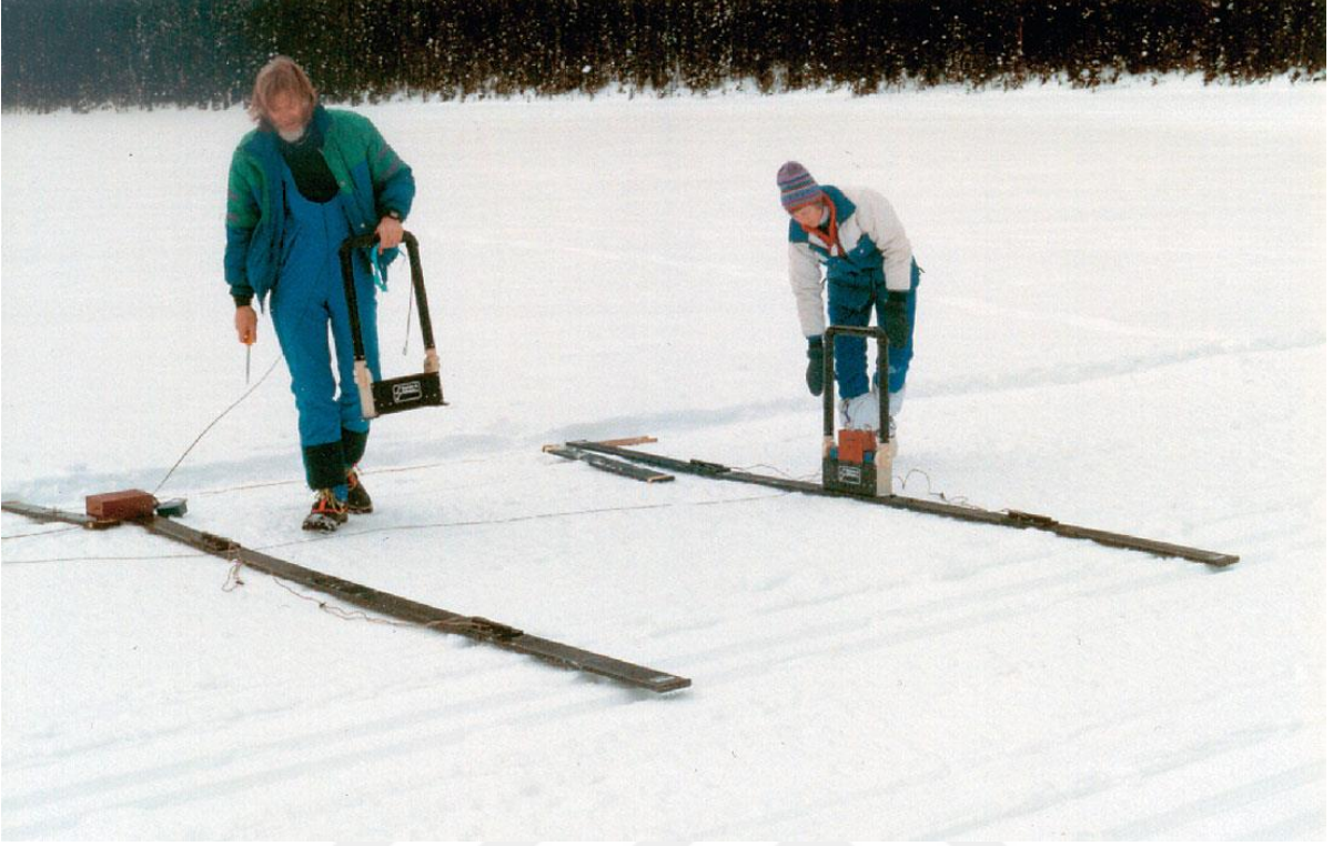
Şekil 2.9 Düşük Frekans Anten (Arcone [49]).
