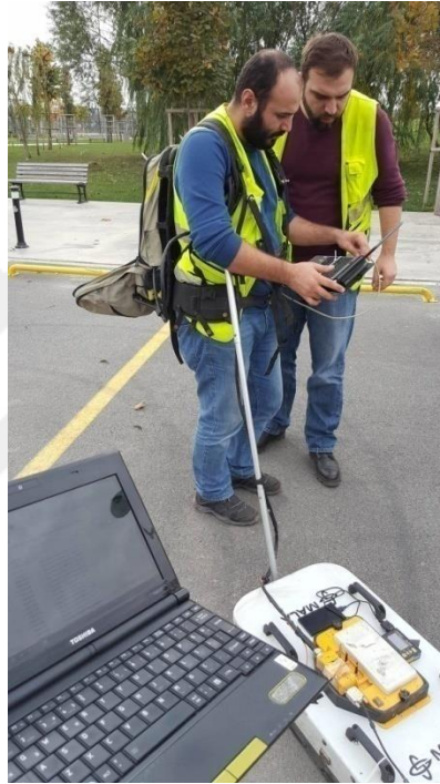
Şekil 4.13 GPR-GPS ve İnklinometre için data logger bağlantısı ve eşzamanlı veri kaydı.
