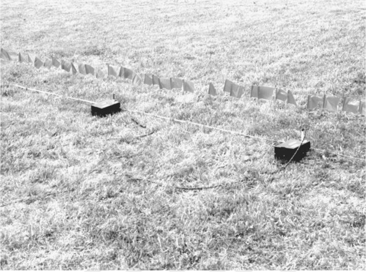
Şekil 2.17 CMP Testi yapılırken antenler alıcı verici antenler birbirinden ayrılır ve antenler arası bilinen mesafe aşama aşama artırılarak her bir anten konumu için yansıma izleri ayrı ayrı kaydedilir (Fisher vd. [41]).
