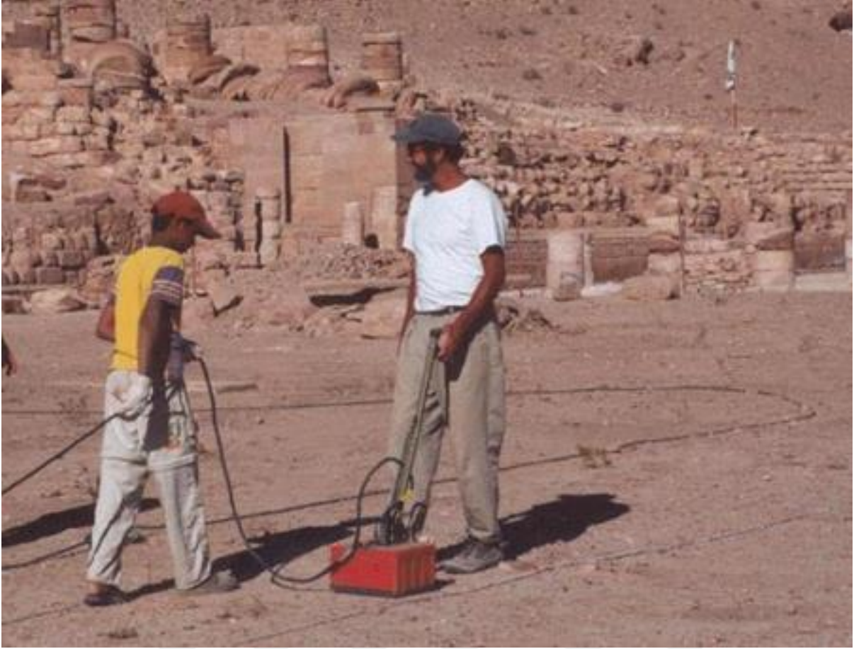
Şekil 2.4 GPR anteni ile veri toplama. Yansıma profilleri GPR antenin profil boyunca taşınması ile elde edilir. Bu fiberglas muhafazanın içerisinde 400 Mhz merkez frekansında alıcı ve verici anten çifti bulunmaktadır. Algılanan enerji bir kablo vasıtası ile kontrol ünitesine gönderilir (Leckebusch [24]).
