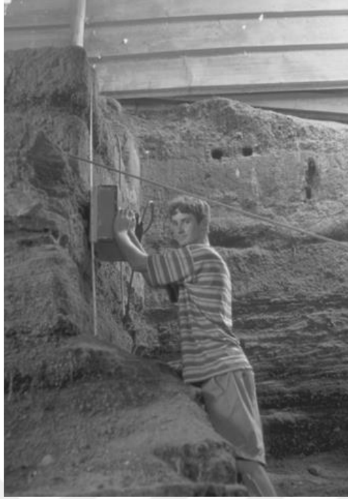
Şekil 2.19 Ara Kesit (Transillumination) testi. Bu test yapılırken antenler düşey kesit üzerinde karşılıklı ve paralel şekilde taşınır. Alıcı ve verici antenler arasında test edilmek istenilen materyalden oluşan arayüzey kesit bulunur (Conyers [73]).
