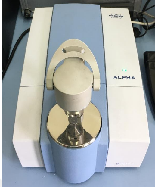
Şekil 6.20'de görülen BRUKER Alpha-P marka FTIR cihazı
