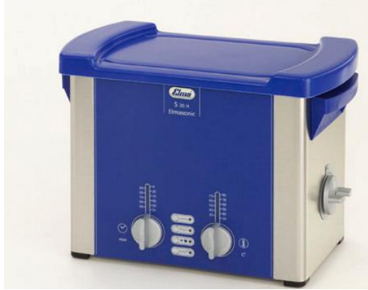
Şekil 6.10 Elma E30H Elmasonic ultrasonik banyo
