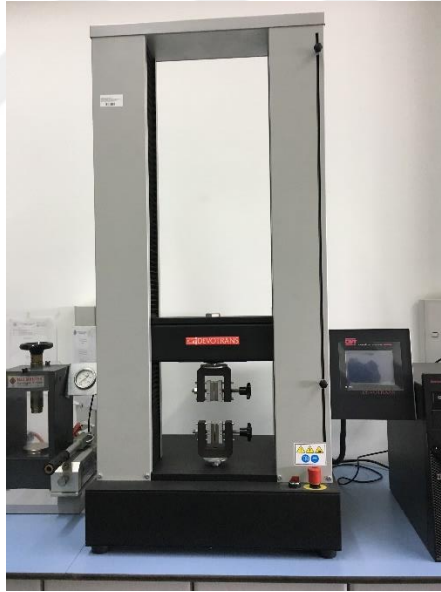
Őekil 6.18 Devotrans 161070 CKS GP Mekanik analiz cihazı
