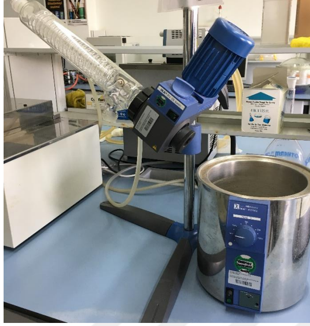
Şekil 6.12'de görülen IKA RV 0.5 BASIC rotary evaporator
