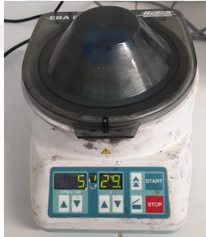
Şekil 6.8 Hettich EBA-20 model santrifüj cihazı
