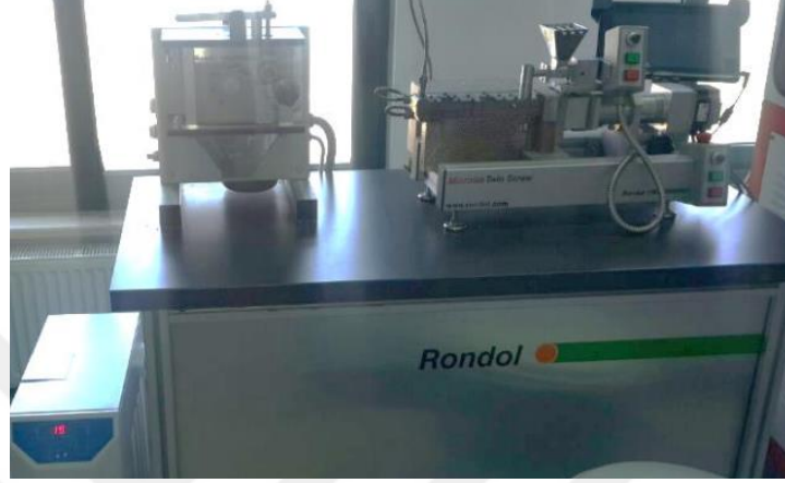
Şekil 6.12 Rondol Microlab laboratuvar ölçekli çift vidalı ekstrüder
