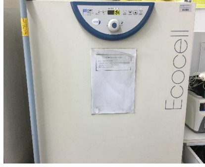
Şekil 6.19 Ecocell hava sirkülasyonlu etüv
