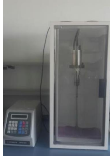
Şekil 6.5 SONICS Vibra Cell ultrasonik prob
