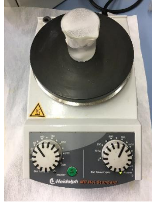
Şekil 6.6 Heidolph Mr-Hei Standart manyetik karıştırıcı
