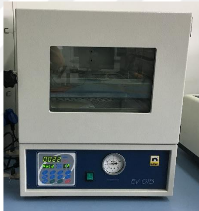
Şekil 6.14 Nüve 018 vakum etüvü
