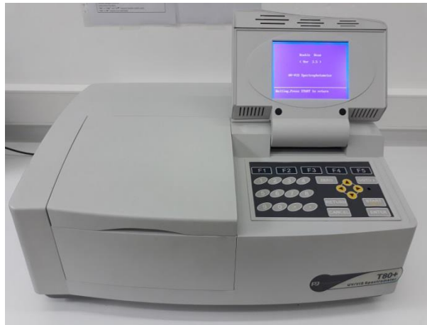
Şekil 3. 4 PG T80+ UV-Vis Spektrofotometre cihazı
