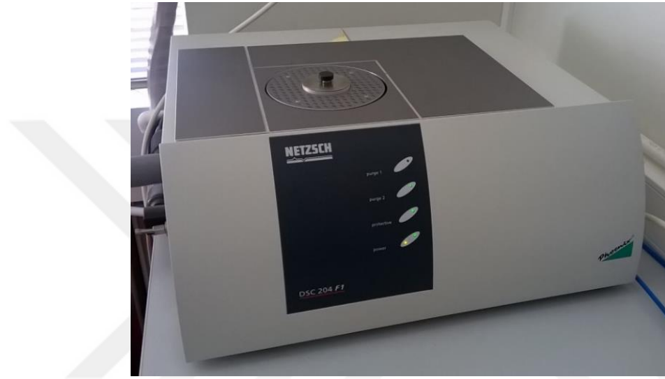
Şekil 3. 6 Netzsch 204 F1 DSC cihazı
