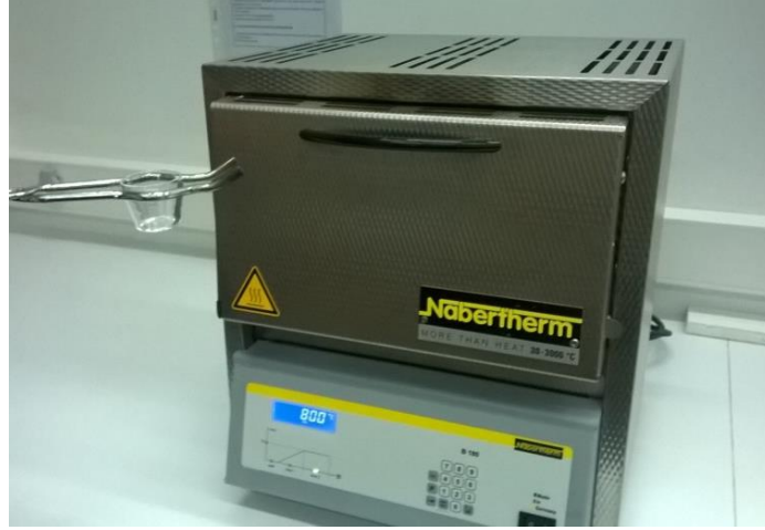
Şekil 3. 2 TWN numuneler için ergitme düzeneği
