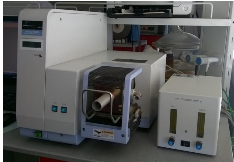
Şekil 3. 5 Perkin Elmer™ Diamond TG/DTA cihazı
