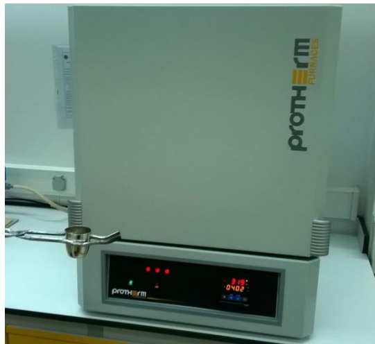
Şekil 3. 1 SNCA numuneler için ergitme düzeneği
