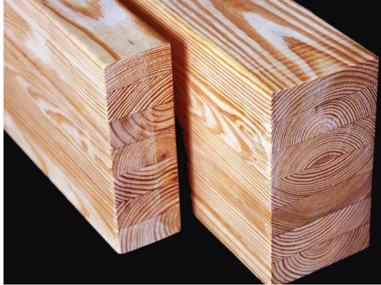
Şekil 2. 3 Glulam yapı elemanı katman detayı [17]
