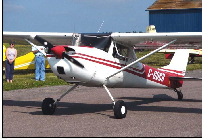
Şekil 2. 1 Kuyruk iniş takımı örneği (Tailwheel landing gear) [12]
