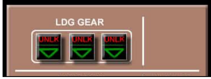
Şekil 2. 8 Airbus A320 uçağına ait iniş takımı göstergesi [19]
