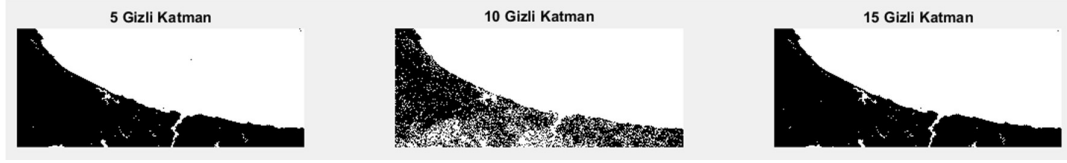
Şekil 4. 55 2000 iterasyon ve sırasıyla 5-10-15 gizli katman sayılı SOM – ANN ağlarının sonuç görüntüleri (SOM – ANN-3 – Varsayılan)
