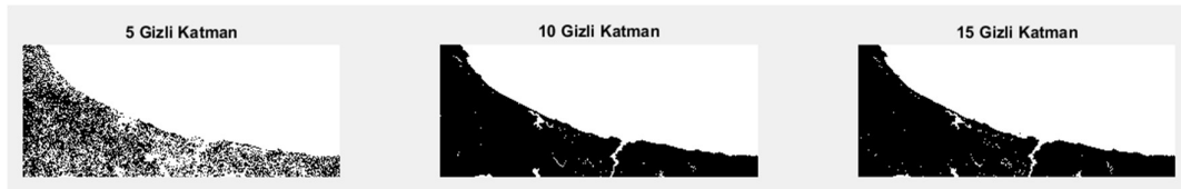
Şekil 4. 43 1000 iterasyon ve sırasıyla 5-10-15 gizli katman sayılı ANN ağlarının sonuç görüntüleri (ANN-3 – Varsayılan)
