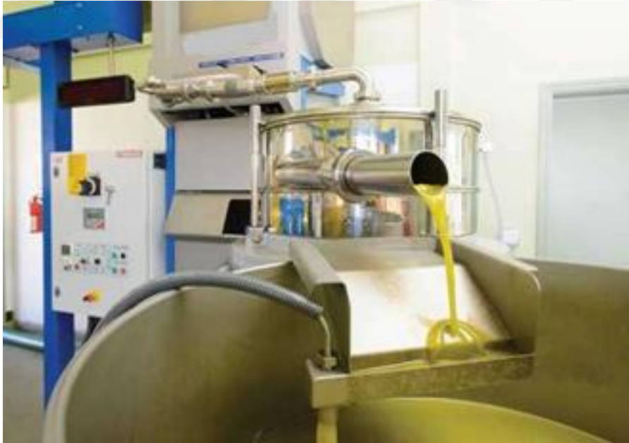
Şekil 2.7 Zeytinyağı dekantör sistemi [58]
