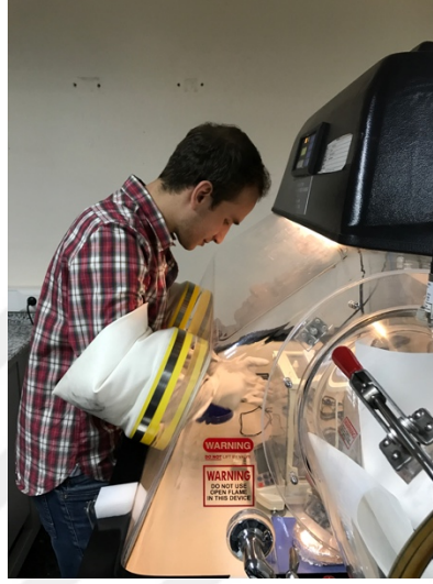
Şekil 3.4 NbCl_5 'in vakum odasında çözeltiliye alınması
