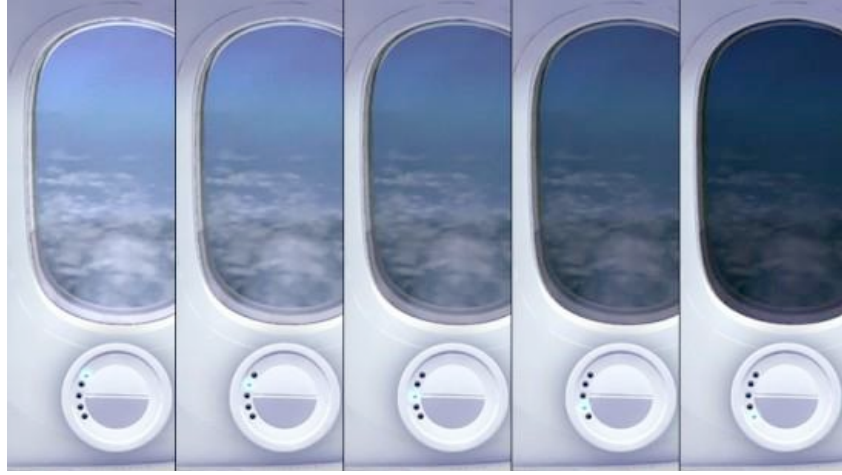
Şekil 2.4 Boeing 787 Dreamliner yolcu uçaklarında kullanılan elektrokromik pencereler [21]
