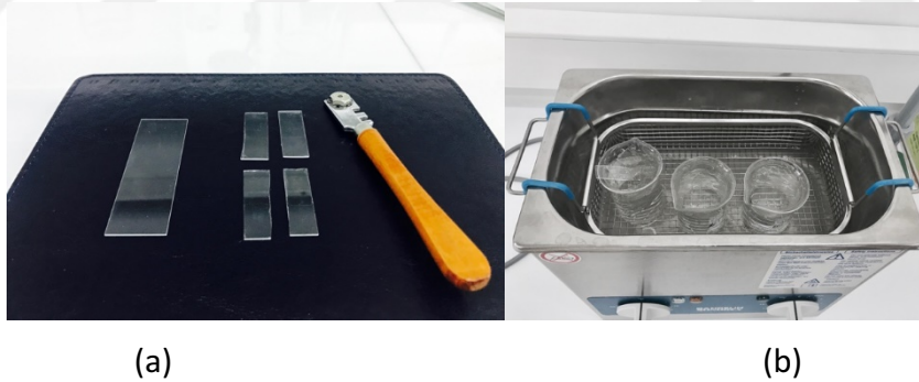
Şekil 3.1 (a) cam altlıkların uygun boyutlarda kesilmesi (b) ultrasonik banyoda altlıkların temizlenmesi
