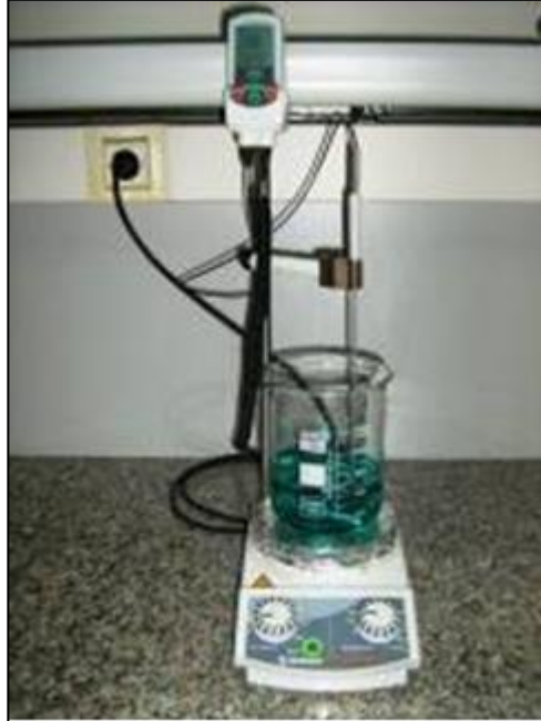
Şekil 4.3 Akımsız nikel kaplamanın yapıldığı manyetik karıştırıcı
