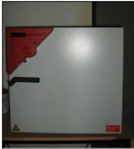
Şekil 4.6 Nikel kaplanan partiküllerin kurutulmasında kullanılan etüv
