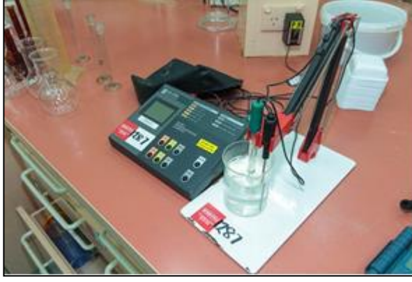
Şekil 4.4 Kaplama banyosunun pH'ının kontrol edildiği pH metre
