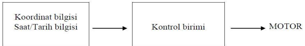
Şekil 5.6 Açık döngü sistemine ait blok diyagram [37]
