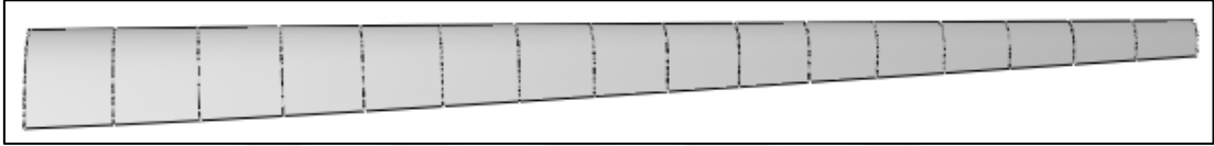
Şekil 7.21 Kord dağılımı lineerleştirilmiş DU 91-W-2250LM/ AH 93-W-257/ NACA 64618 kanadı
