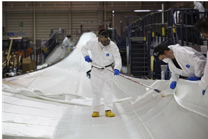
Şekil 1.4 Cam Fiberi katman serimi, Gamesa Corp Tecnologica SA, İspanya
