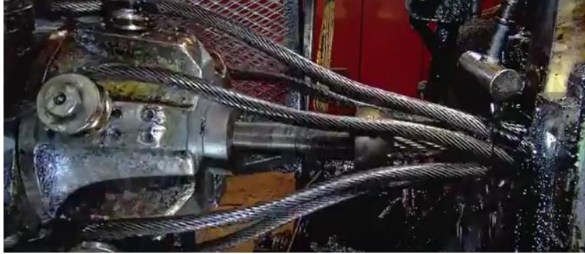
Şekil 3. 7 Halat kapatma işlemi
