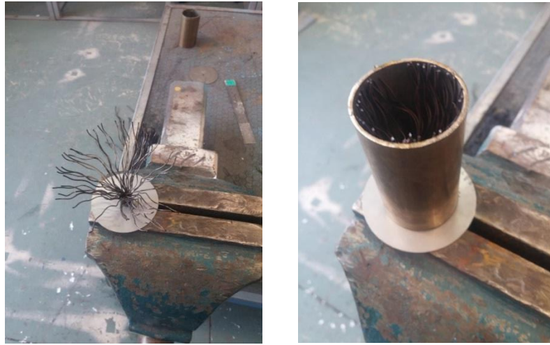
Şekil 7. 8 Delikli parça ve kullanılan kalıp
