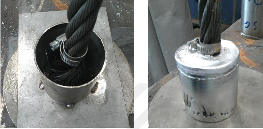
Şekil 7. 7 D numunesi kalıbı ve dökülmüş numune
