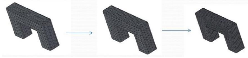
Şekil 5. 1 Sonlu elemanlara ayrılmış model
