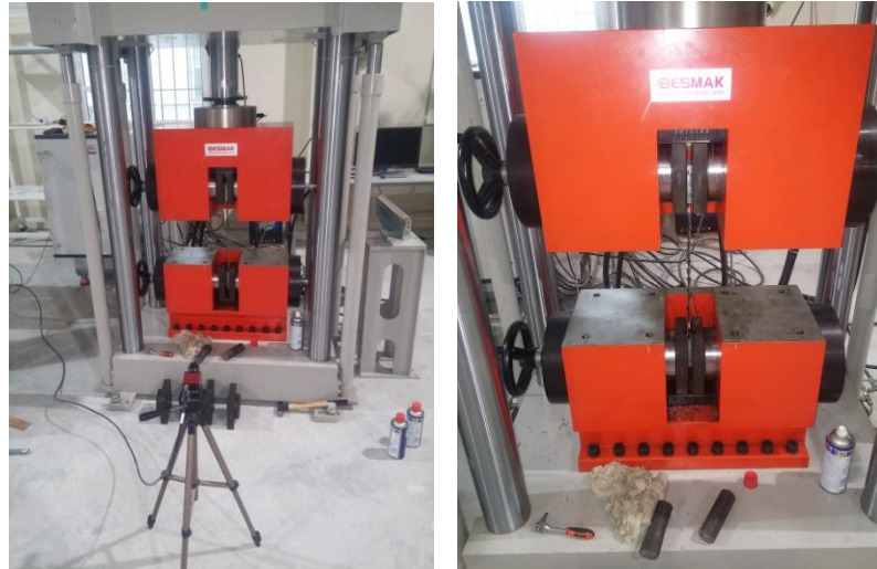
Şekil 7. 14 K ve I numuneleri çekme işlemi
