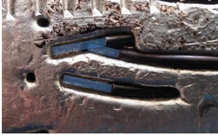
Şekil 7. 13 D numunesi tel kayması
