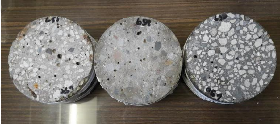
Şekil 4.14 Deney sonrası tipik görünüm (Ortadaki numune normal agregalıdır)
