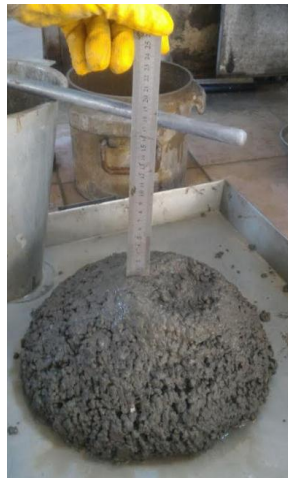
Şekil 4.6 Hafif agregalı normal ve kendiliğinden yerleşen beton numuneler
