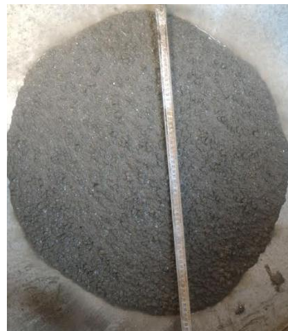
Şekil 4.6 Hafif agregalı normal ve kendiliğinden yerleşen beton numuneler
