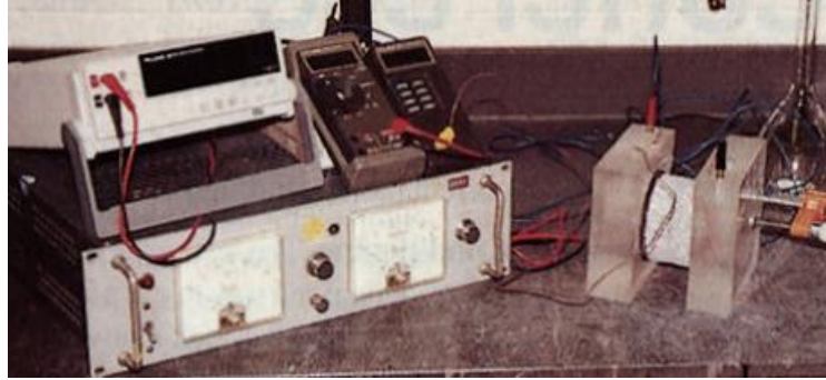
Şekil 4.13 ASTM C1202-12 Standardına göre deney düzeneği
