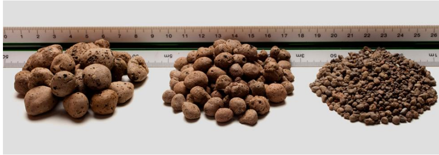
Şekil 3.6 Boyutlarına göre tasnif edilmiş geliştirilmiş kil agregalar [51]
