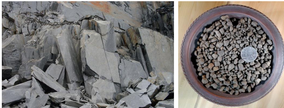
Şekil 3.5 a) Doğal arduvaz kayaç formu [50] b) Genleştirilmiş arduvaz agregası [50]
