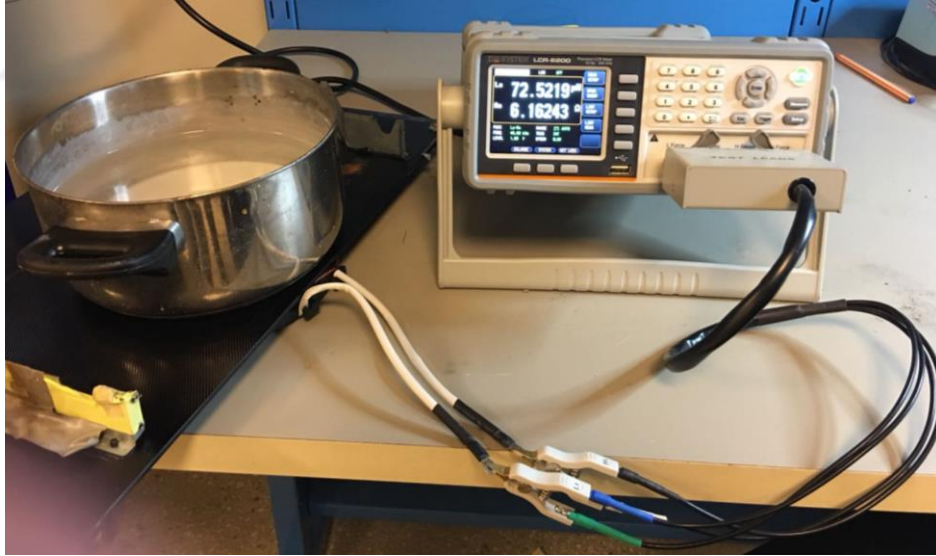
Şekil 7.2 Çelik tencere ve LCR metreden oluşan ölçüm düzeneği
