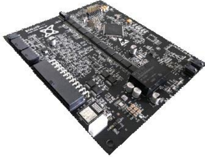
Şekil 5.14 Tasarlanan BYS ana elektronik kartı
