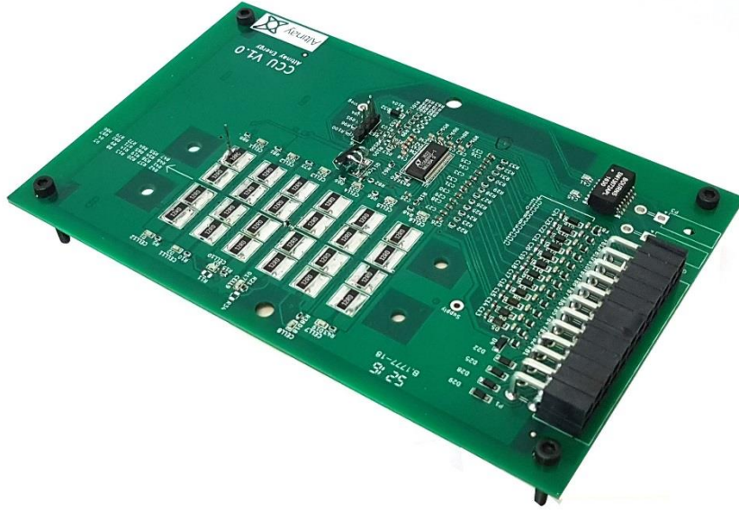
Şekil 5.3 Tasarlanan BYS uydu elektronik kartı
