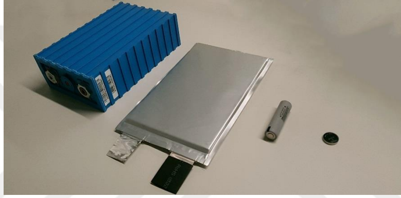
Şekil 3.2 Farklı fiziksel yapıdaki lityum iyon hücreler
