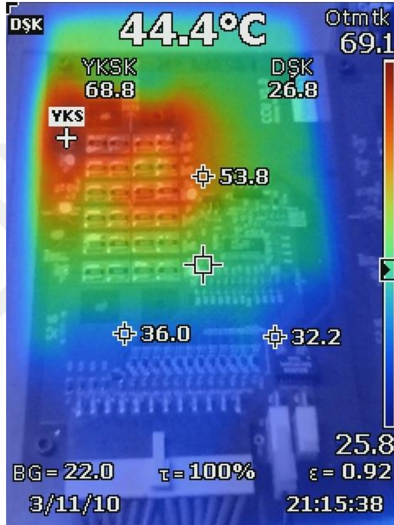
Şekil 6.9 Uydu kartın dengeleme sürecindeki termal görüntüsü
