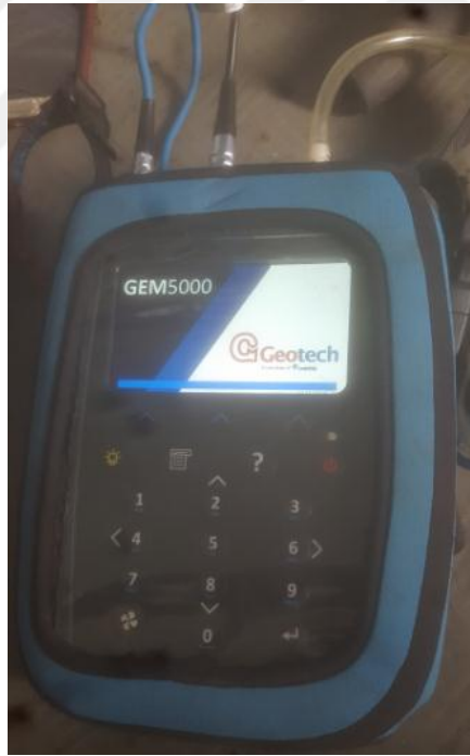
Şekil 4.10 Giriş atık gazında ölçüm yapılan cihaz (GA5000)
