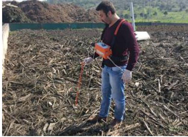
Şekil 4.8 PORTAFID® M3K model cihaz ile sahada yapılan bir ölçüm
