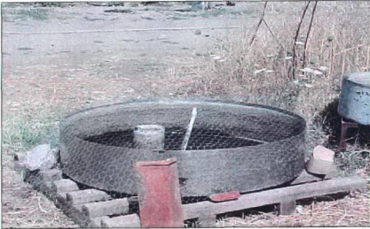
Şekil 3.2c .Buharlaşmayı belirlemek amacıyla kullanılan Class A pan
