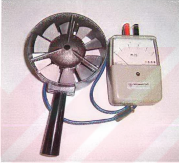
Şekil 3.5 Hava hızının ölçümünde kullanılan anemometre
