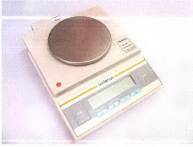
Şekil 3.6 Gübre örneklerinin tartılmasında kullanılan SARTORIUS BL610 terazi.
