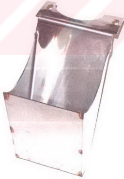
Şekil 4.6 Yönlendirici 2 (gübre disk üzerine geniş kesitte bırakılmakta)
