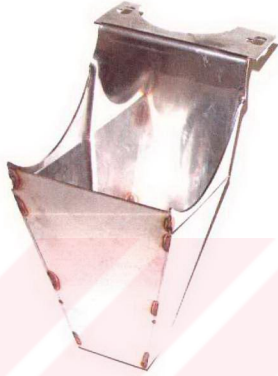
Şekil 4.5 Yönlendirici 1 (gübre disk üzerine dar kesitte bırakılmakta)
