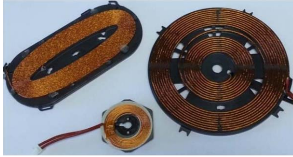
Şekil 3.13 Isıyı homojen dağıtmak için tasarlanan bobinler [3]
