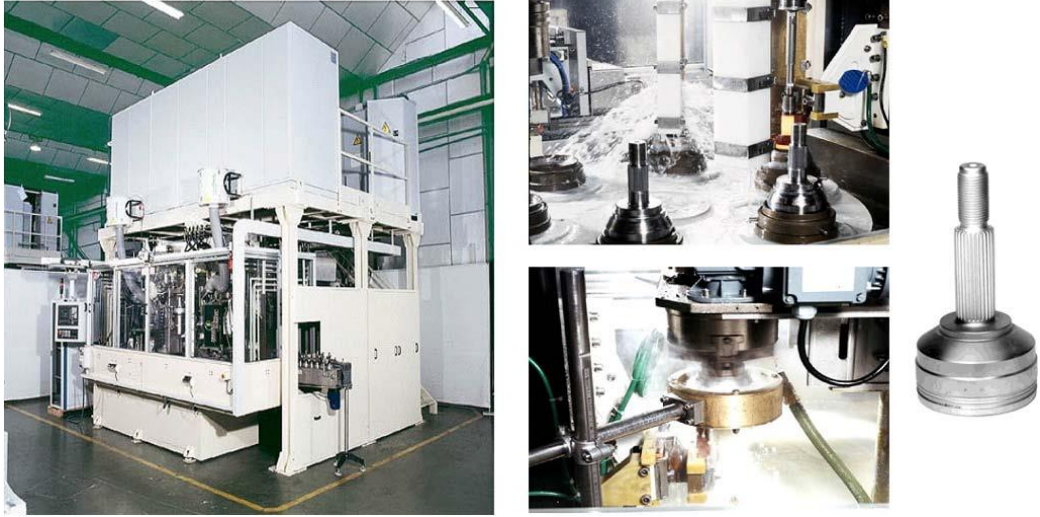
Şekil 3.9 Endüksiyonla ısıtma uygulamalarında metal sertleştirme uygulaması [3]
