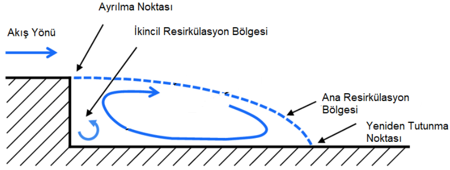
Şekil 1.12 Step akımındaki ayrılma alanı [63]
