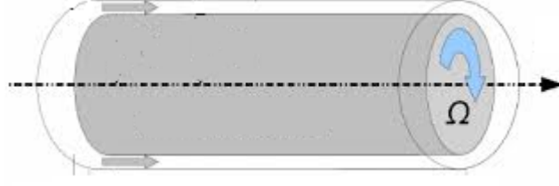
Şekil 1.5 Taylor-Couette-Poiseuille akımının şematik görünümü
