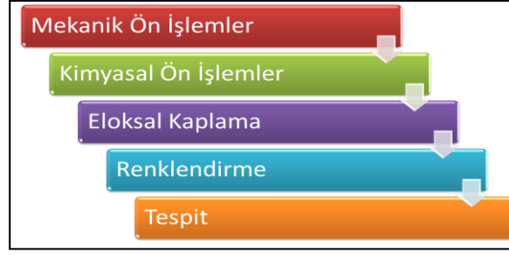
Şekil 2.1 Eloksal kaplama prosesi işlem adımları
