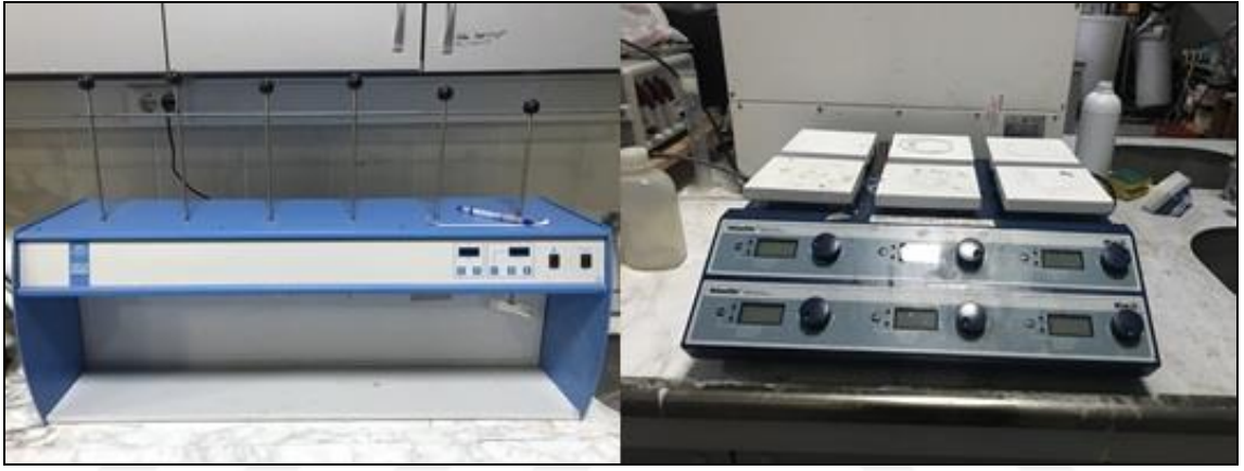
Şekil 3.1 Laboratuvar ölçekli jar testi düzenegi
