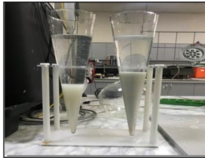
Şekil 3.2 İmhoff hunileri ile çamur çöktürme düzenegi
