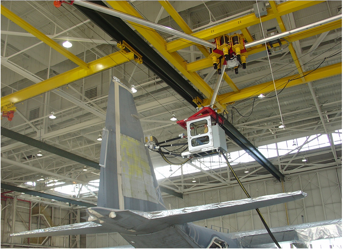
Şekil 1.1 Uçak Hangarındaki RoboCrane Manipölatörü[7]
