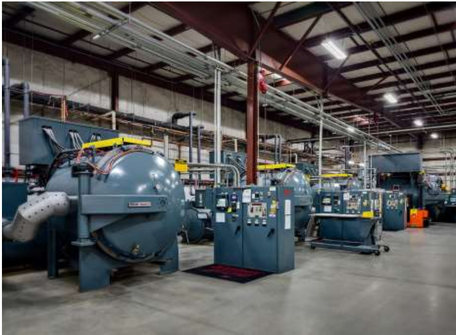
Şekil 3.11 Vakum ortamında sert lehimleme için kullanılan fırınlar [45]
