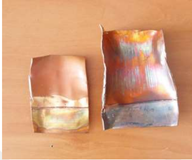
Şekil 4.1 Bakır borularda azot kullanılarak ve azot kullanılmadan yapılan sert lehimleme işlemleri
