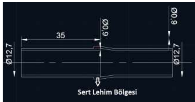
Şekil 6.1 Bindirme yöntemiyle sert lehimlenmiş bakır boru numune boyutları
