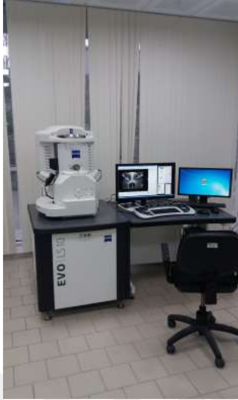
Şekil 6.5 Yüzey incelemesinde kullanılan SEM görüntüleme cihazı
