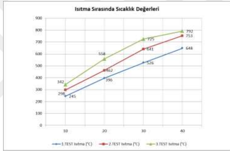
Şekil 7.1 Bindirme yöntemi ile azot gazı kullanılmadan yapılan sert lehimleme işleminde bağlantı bölgesinde ısıtma sırasındaki sıcaklık değişimleri
