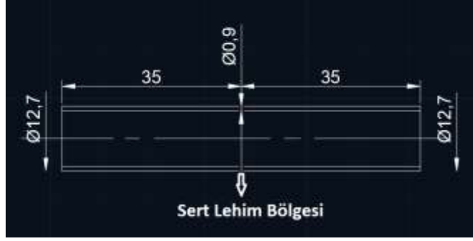
Şekil 6.2 Alın altına yöntemiyle sert lehimlenmiş bakır boru numune boyutları
