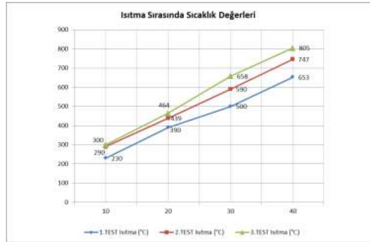
Şekil 7.2 Bindirme yöntemi ile azot gazı kullanılarak yapılan sert lehimleme işleminde bağlantı bölgesinde ısıtma sırasındaki sıcaklık değişimleri
