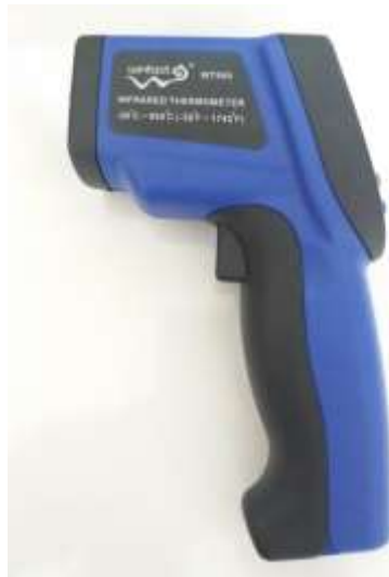
Şekil 6.3 Sıcaklık ölçümleri yapılan lazer termometre
