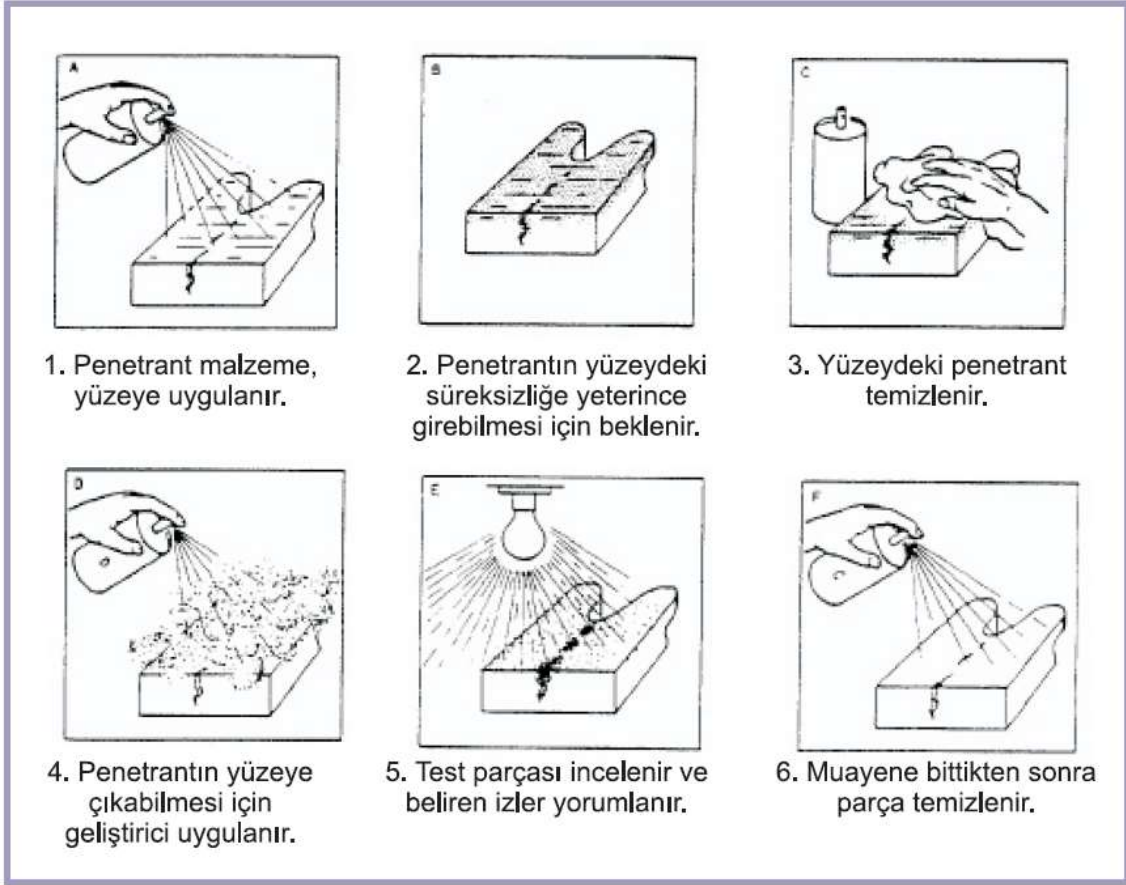
Şekil 5.1 Sıvı penetran ile muayenenin temel aşamaları [40]
