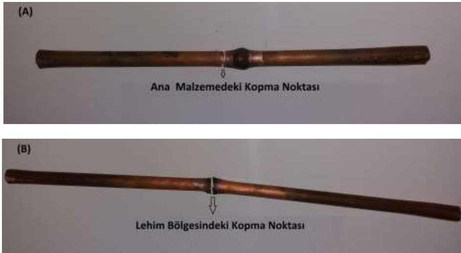
Şekil 7.7 Çekme testi sonrasında bindirme yöntemiyle birleştirilip sert lehimlenmiş bakır boruların kopma noktası (A) 750 °C ve 800 °C, (B) 650 °C
