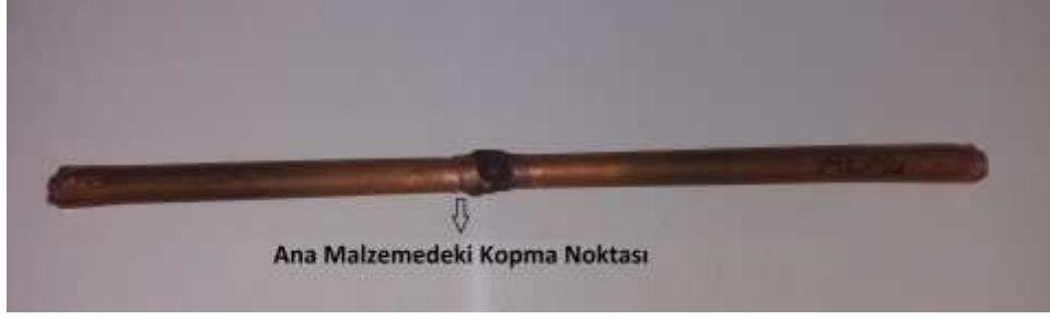
Şekil 7.8 Çekme testi sonrasında 750 °C sıcaklıkta alın alına yöntemle birleştirilip sert lehimlenmiş bakır boruların kopma noktası
