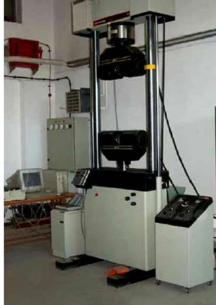
Şekil 5.3 Çekme Deneyi Makinesi [39]
