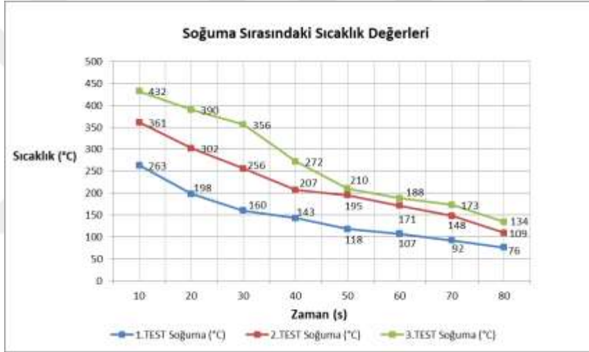
Şekil 7.4 Bindirme yöntemi ile azot gazı kullanılarak yapılan sert lehimleme işlemi sonrasında oda sıcaklığında soğuma sırasında bağlantı bölgesinin sıcaklık değişimleri
