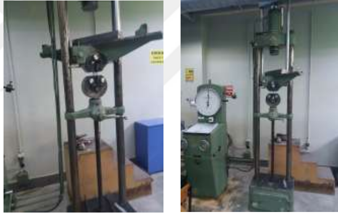
Şekil 6.4 Deneyde kullanılan çekme makinesi
