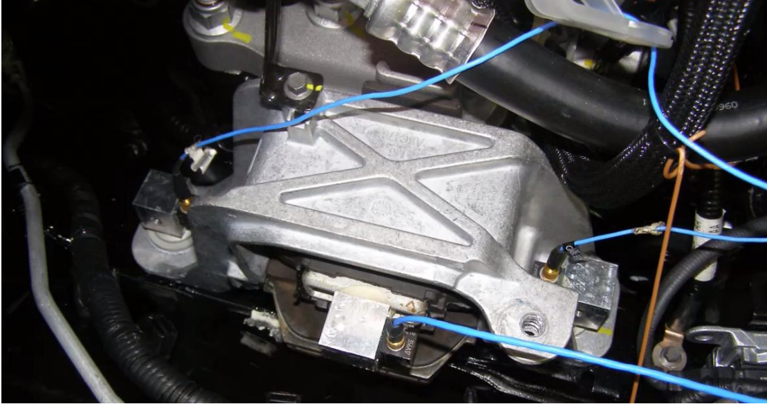
Şekil 3.4 Araçta Motor Takozundan Titreşim Ölçümü
