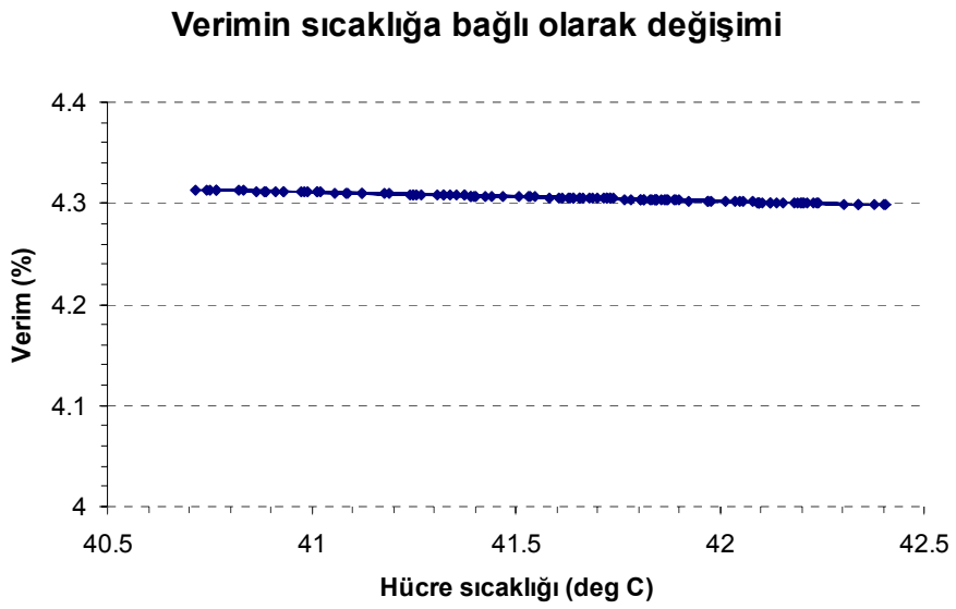
Şekil 4-16 Güneş modülünün veriminin hücre sıcaklığına bağlı olarak değişimi
