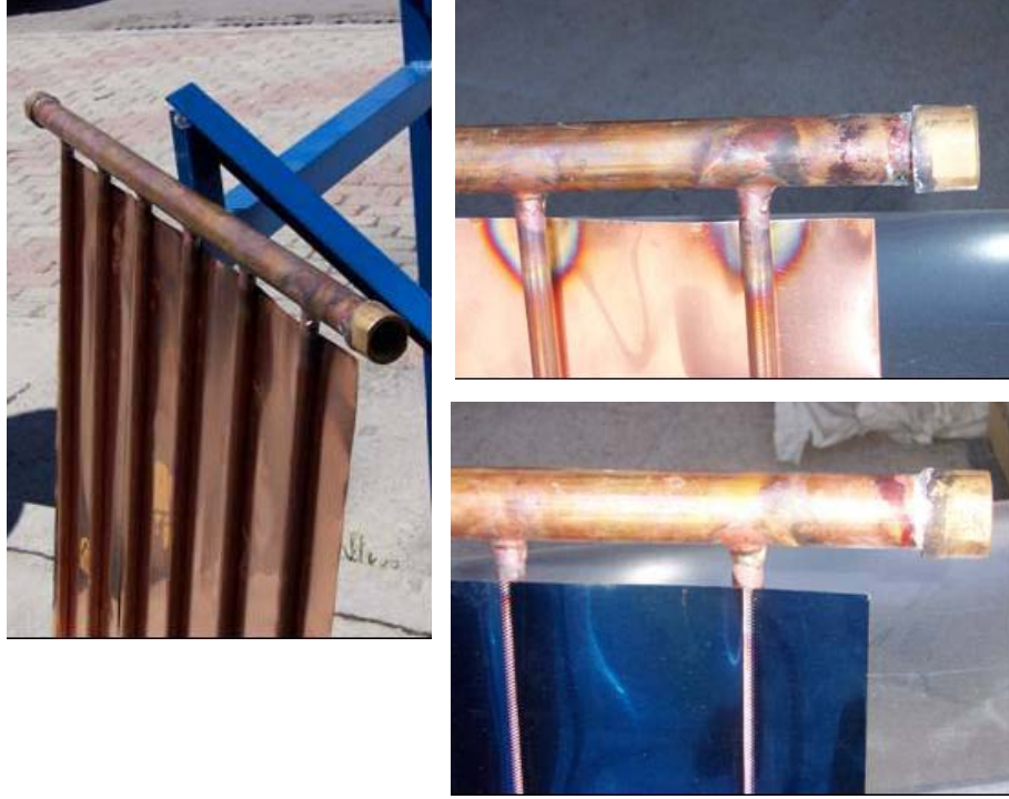
Şekil 3-15 Titanium dioksit kaplamalı yutucu yüzey yapım ayrıntıları.
