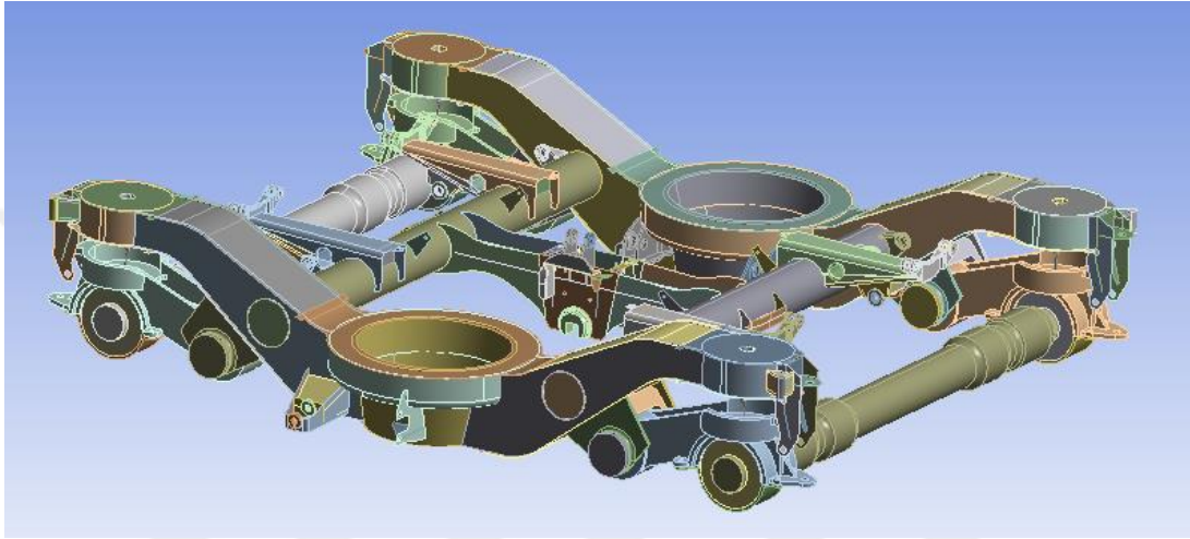
Şekil 11.1 Y32 Boji modelinin Ansys Workbench'e aktarılması
