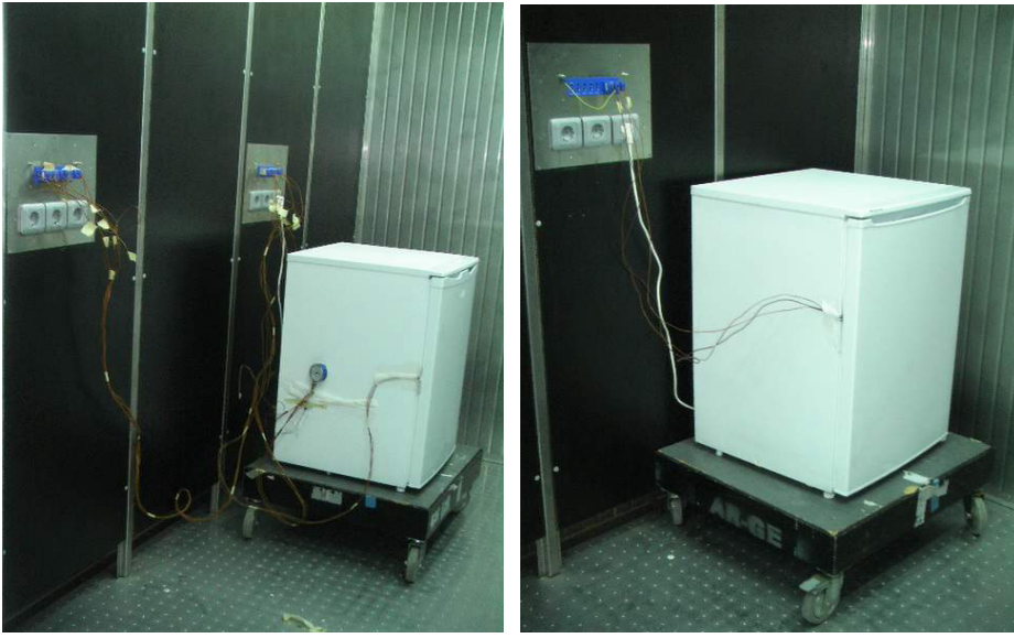
Şekil 5.3.2. İklimlendirme odasında test buzdolabının yerleşimi
