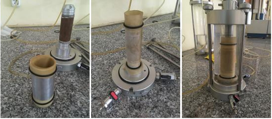
Şekil 3.20 Üç eksenli basınç hücresi, membrana geçirilmiş numune ve su ile doldurulmuş cam hücre
