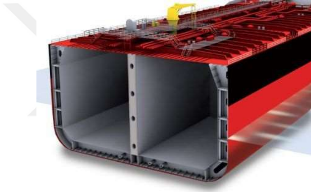
Şekil 2.5 Tanker çift cidar yapısını gösteren kesit
