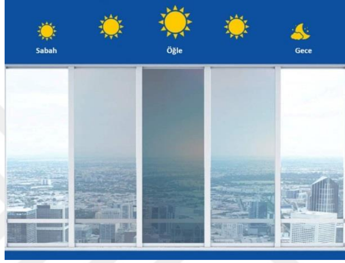
Şekil 4.13 Foto Kromatik film kaplı cam değışimi [119]
