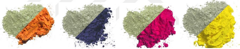
Şekil 4.15 Foto Kromatik pigment renk değişimi [123].
