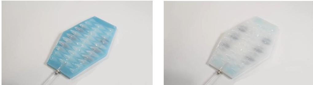
Şekil 4.21 Prototipe sıcaklık uygulandığındaki renk değişimi [128]
