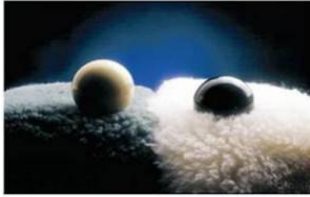
Şekil 2.7 Yapay Pösteki ile Gerçek Pösteki (soldaki) Arasında Ağırlığı Destekleme Farkı
