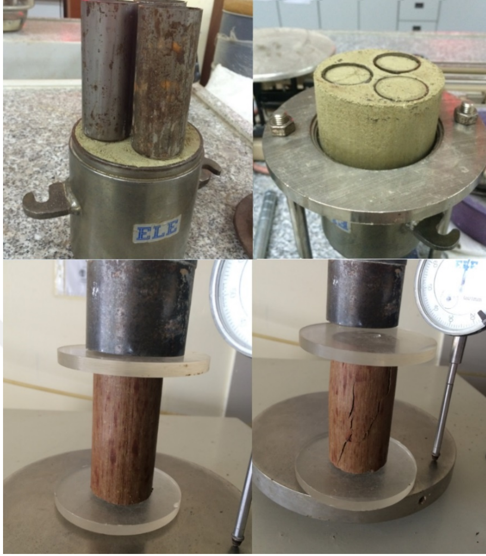
Şekil 3.9 Serbest basınç deneyinin aşamalarına ait görsel.
