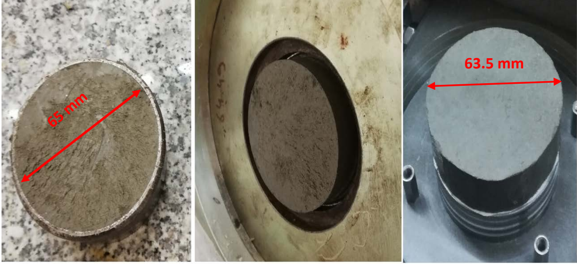
Şekil 3.12 Dinamik basit kesme için numune hazırlanması.
