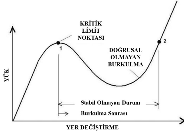
Şekil 3.5 Vurgu stabilitesi yük - yer değiştirme gösterimi [55]
