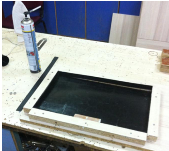
Şekil 6.10 Kovan ön duvar kalıbı
