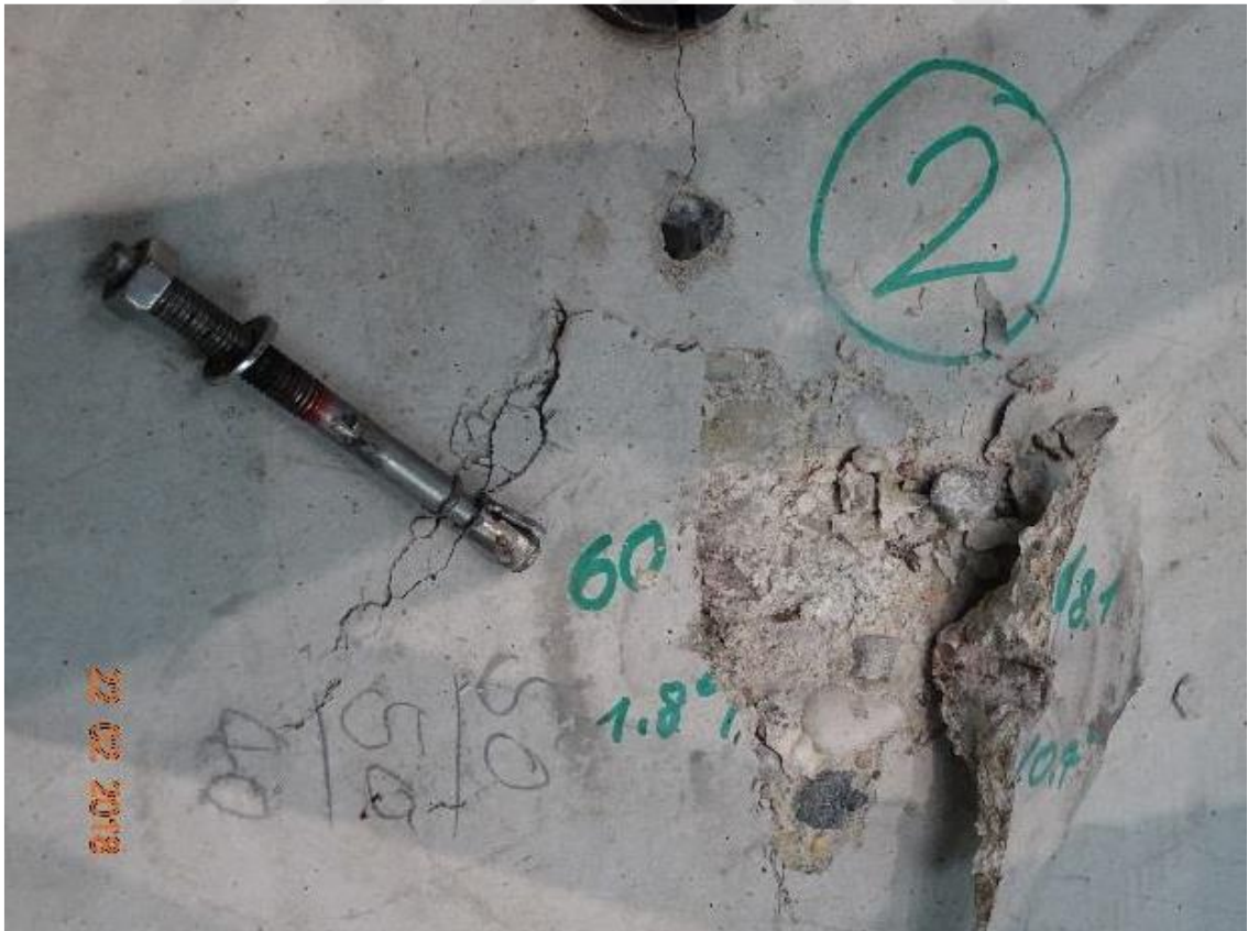
Şekil 2.21 Yorulma testinde beton kopma hatası
