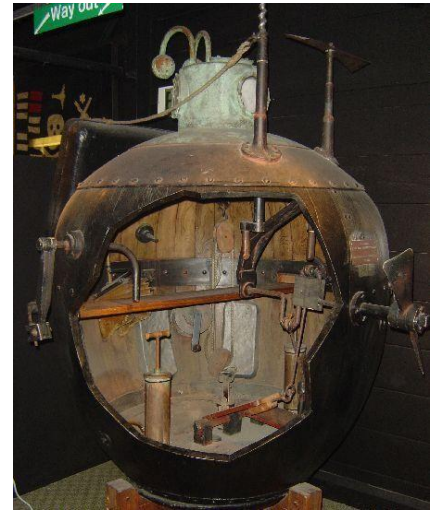
Şekil 3.3 Turtle denizaltı kesit, görünüşü [41] ve müzede sergilenen modeli [42]
