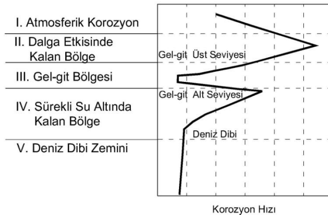
Şekil 4.12 Çeliğin deniz ortamında korozyon hızı [95].
