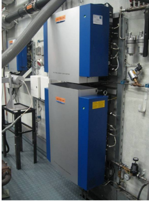
Şekil 2.3 Deneilerde kullanılmış olan AVL 735S ve AVL 753C kombinasyonu
