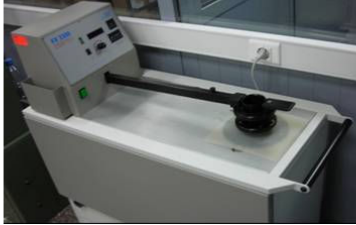
Şekil 4.7 Air Permeability Tester FX 3300
