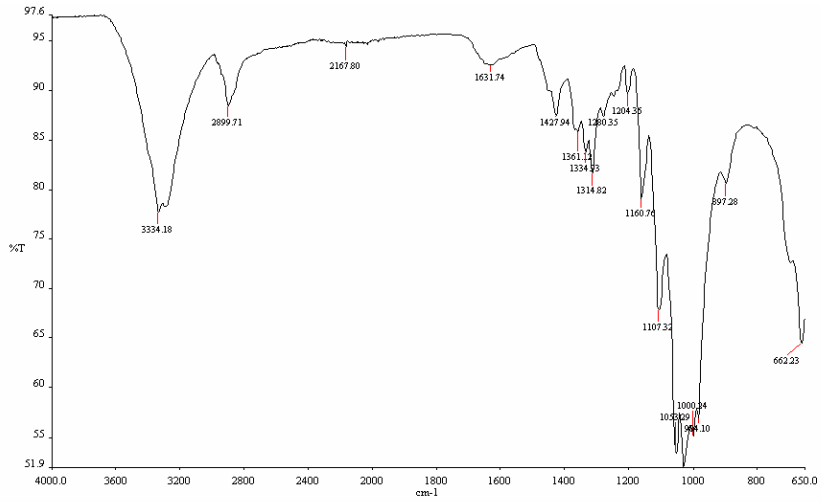
Şekil 5.63 Cibafix Eco ile işlem gören numunenin FT-IR spektroskopisi
