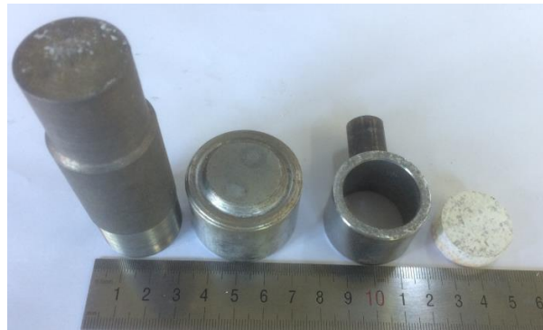
Őekil 6. 12 Presleme kalıbı ve preslenmiş numune örneđi
