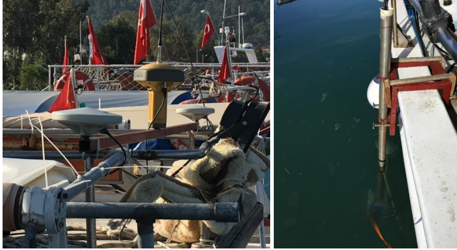
Şekil 3.5 Tekneye konumlandırma ve iskandil sistemlerinin kurulumu
