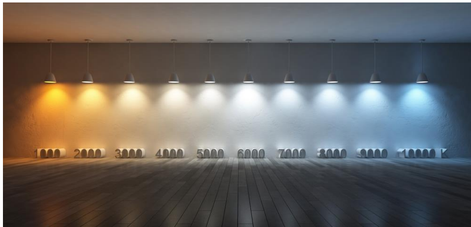
Şekil 3.9 1000K-10000K aralığındaki renk sıcaklıklarının şematik ifadesi [55].
