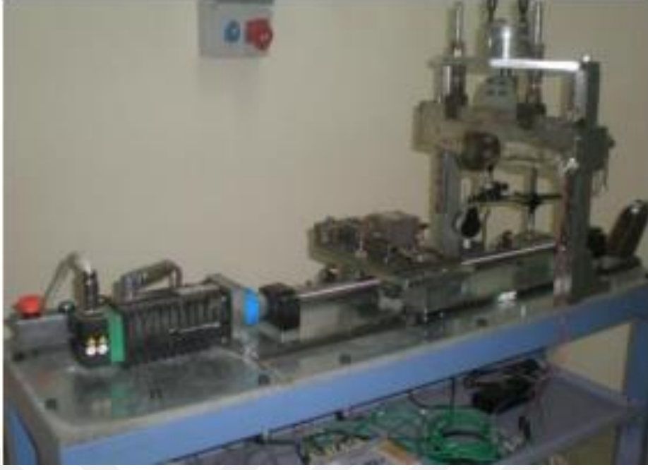
Şekil 4.3 Deneylerde kullanılan bilgisayar kontrollü ani duruşlu ortogonal talaş kaldıran cihaz
