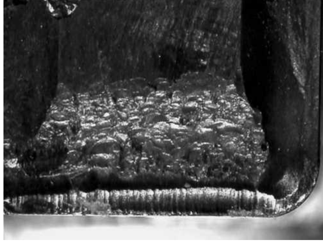
Şekil 2.13 Nikel Alaşımı İşlemede Kullanılan Kaplamalı Karbür Uçta Oluşan Talaş Çekiçlemesi [9]
