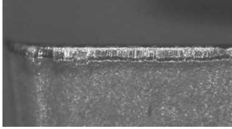
Şekil 2.8 Yüksek Grafitli Çelik Malzemede Kullanılan Kaplamalı Uçlarda Termal Çatlaklar (Sulu Kesme) [9]
